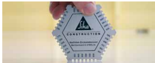
Sprawdzanie grubości nałożonej warstwy
