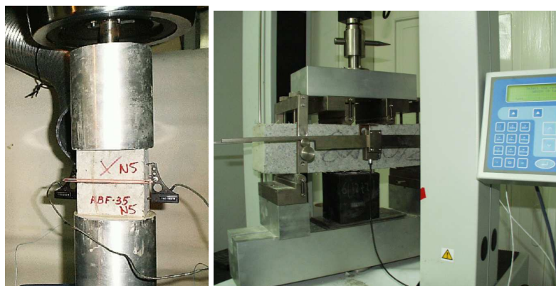
Rys. 6. Doświadczalne określanie wytrzymałości resztkowej na rozciąganie (osiowe) oraz wytrzymałości równoważnej na zginanie wg JCI SF-4 i ASTM C1018 (IPPT PAN)
