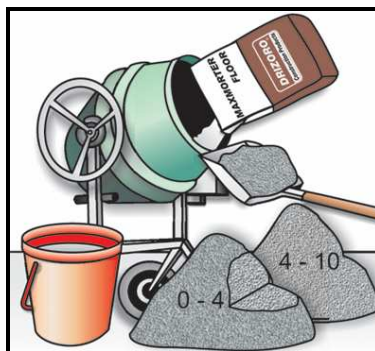
W betoniarnie należy wymieszać spoiwo zmodyfikowane polimerami MAXMORTER FLOOR z kruszywem 0-4 mm oraz żwirem 4-10 mm, a następnie dodać wody. Zużyć w ciągu 30 min.
