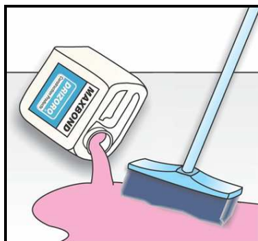
Preparat gruntujący należy rozprowadzić za pomocą szczotki.
